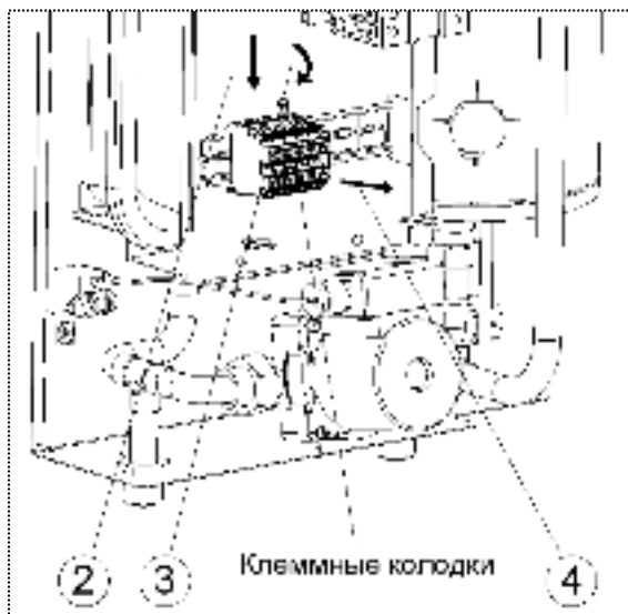
Рисунок 18. Замена клеммных колодок
